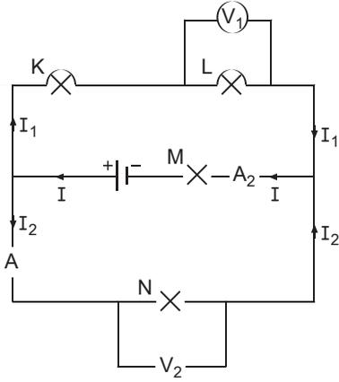
Şekildeki elektrik devresi incelendiğinde K ve L ampulleri seri bağlı olup N ampulüne paraleldirler. K, L ve N ampulleri ise M ampulüne seri bağlıdır.
